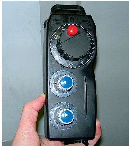
Générateur manuel d'impulsions inclus Impulsgeber in Normalausführung Manual Pulse Generator included
