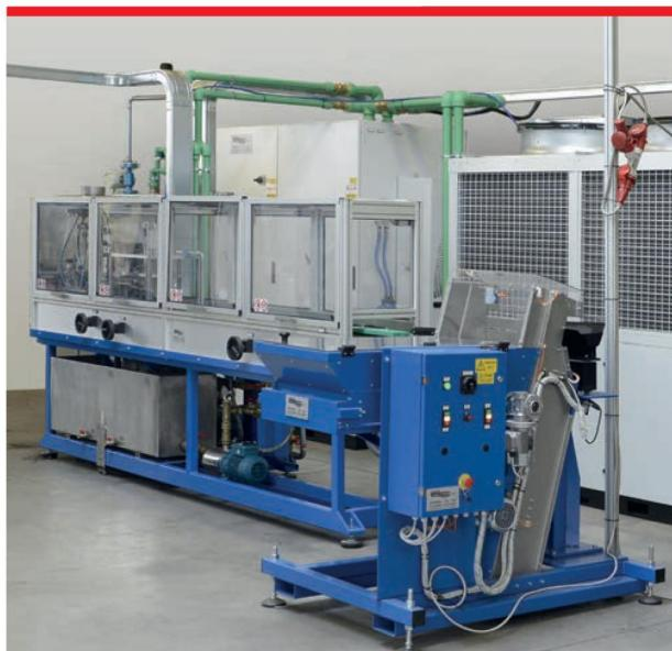
**Impianto di tempra per perni e boccole** alimentazione a spinta continua dei pezzi con tempra a profilo e interrotta
