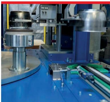
Impianto automatico di riscaldo di fondelli pentola con sistema ad impatto, attrezzatura automatica di carico/scarico pezzi
