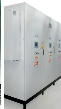
**Impianto di tempra verticale doppio** con dispositivo di centraggio pezzi, programmazione guidata al ciclo di trattamento, predisposizione al carico robotizzato.
