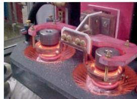
**Impianto di tempra verticale a tavola rotante** per il trattamento simultaneo di due pezzi, alimentazione automatica da nastro trasportatore e carico/scarico pezzi automatizzato.
