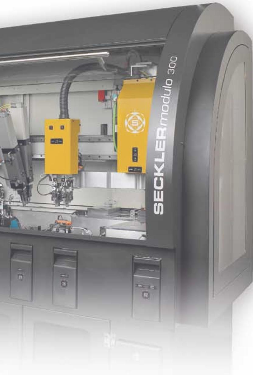
Zudem wird der Data-Matrix-Code auf dem Werkstück mit einer Kamera gelesen. Dieser dient der Identifizierung des Werkstücks und stellt die Verbindung von der SECKLER *modulo* Steuerung zur Datenbank des Kundenleitrechners her.
