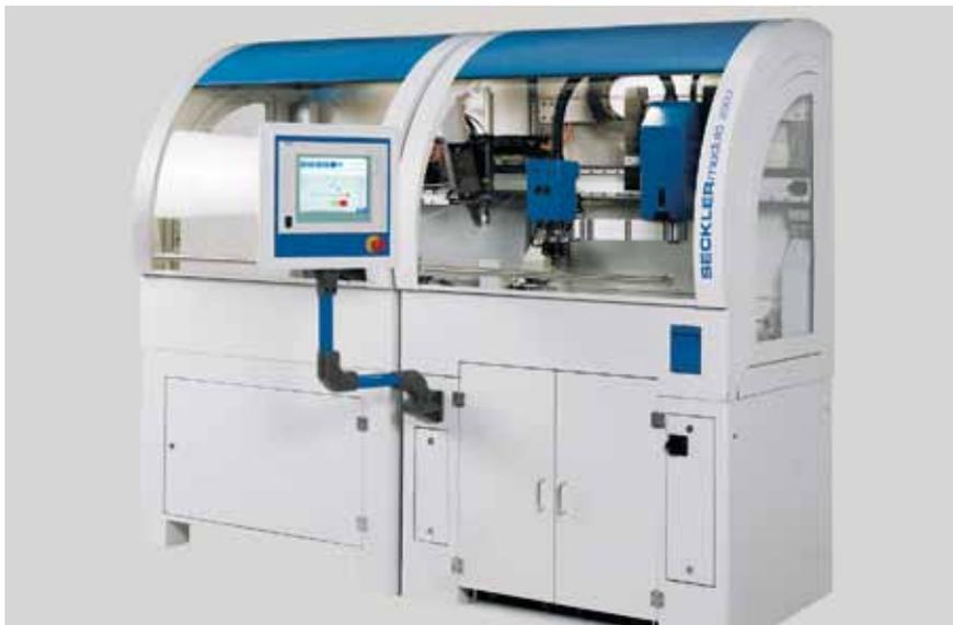
*Doppelzelle: Erweiterung durch Verbindung mehrerer modulo Zellen*
