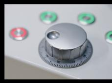
Ein Handrad mit Skala auf der rechten Seite des Bedieners ermöglicht den direkten Zugriff auf das Programm, auch während des Zyklus, um Parameter zu korrigieren.
