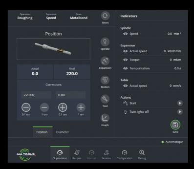
Das Beckhoff-HMI ermöglicht das Speichern von mehreren hundert Programmen sowie das Exportieren und Importieren von Programmen in ein externes System.
