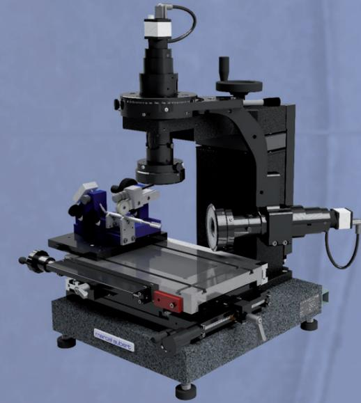
**Doppeloptik für die Schneidwerkzeug-Vermessung**
