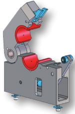
**Die hydrostatischen Lagerungen** garantieren eine perfekte Führungsqualität auch bei höchsten Drehgeschwindigkeiten, weil das hydrostatische Lagerungsprinzip für jede noch so hohe Spindeldrehgeschwindigkeit nicht limitierend wirkt. Das in diese Lagerungen eingespritzte Öl absorbiert die Vibrationen und hält den Reibungsverlust der Stangen auf dem absoluten Minimum. Die maximale Leistung wird erreicht, wenn das Spiel zwischen den Durchmessern der Führungsschalen und der Stange 1 mm beträgt.
