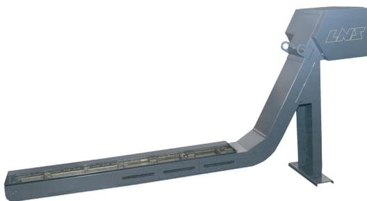
Der Turbo MS500 bewältigt leichte und mittlere Lastmengen von Messing, Stahl, Gusseisenspänen. Er ermöglicht eine Kühlmittelfilterung bei einem Nennwert bis 500µm. Dieser Förderer eignet sich perfekt für die Entfernung von Spänen, die bei der Bearbeitung von Gusskomponenten und Metallteilen entstehen.
