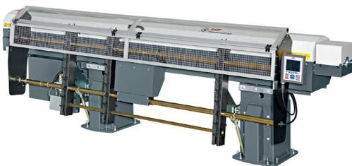
Das für mittlere und grosse Produktionsserien mit Durchmessern von 5 bis 65 mm entwickelte SPRINT 565 S2 ist ein automatisches Stangenlademagazin für Drehautomaten mit festem Spindelstock. Das 565 S2 ruht auf verstärkten Füßen und stabilem Basisträger die alle Teile des Geräts tragen, eine maximale Stabilität garantieren und Vibrationen vermeiden.
