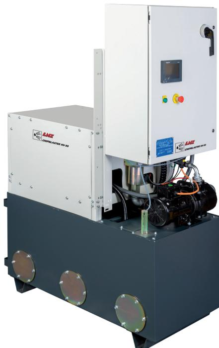
Das automatische CHIPBLASTER Hochdruck-Kühlmittelsystem HV-30 mit variablem Volumen eignet sich ideal für Anwendungen mit hohem Partikelanteil und andere schwierige Einsatzbereiche. Es sorgt automatisch für einen präzisen Kühlmitteldruck und -fluss, verbessert damit die Leistung der CNC-Maschine und erhöht die Standzeit der Schneidwerkzeuge bei nahezu jeder Anwendung.
