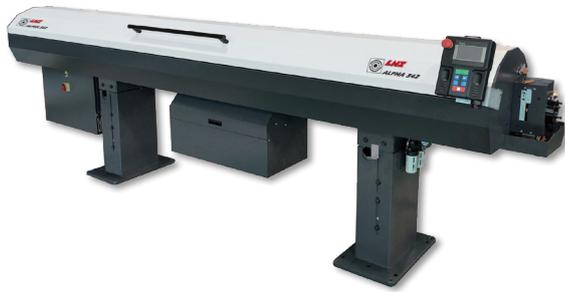
Das ALPHA 342 ist ein zuverlässiges und einfach zu bedienendes Stangenlademagazin. Es wurde für maximale Produktivität und Rentabilität bei Maschinen mit mobilen Spindelstöcken entwickelt. Für lange Stangen mit 3 bis 42 mm.
