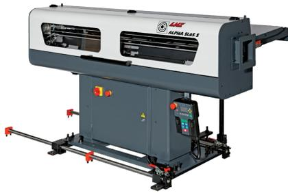
Kostengünstige Alternative beim Beladen von Kurzstangen. Das Alpha SL65 S deckt die Standardbedürfnisse der Beladung von Materialstangen für Mittel- bis Grossserien ab.
