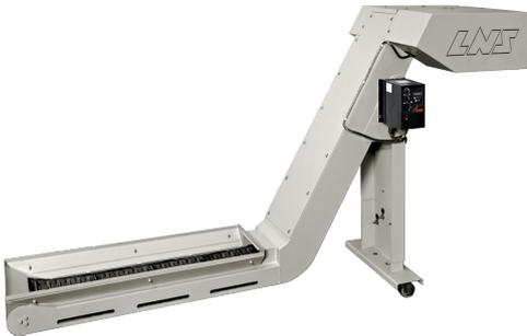
Der Turbo HB ist ein Standardförderer für die Spanentfernung, wenn eine Filterung überflüssig ist. Das Scharnierband eignet sich für alle Anwendungen und ist die beste Wahl für die Entfernung von groben, langen und fadenartigen Spänen.
