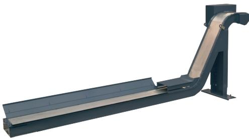
Der Turbo Magnetic verfügt über ein dickes Transportband aus Edelstahl. Es garantiert eine lange Lebensdauer auch bei extremer Belastung. Alle beweglichen Teile befinden sich im Inneren des mit Viton abgedichteten Gehäuses und sind somit nie irgendwelcher, bei der Bearbeitung auftretender Verschmutzung, ausgesetzt. Das Spannen des Transportbandes erfolgt automatisch.
