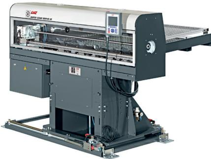
Das Quick Load Servo III+ ist ein polyvalentes Kurzstangenlademagazin. Die Ausrüstung ermöglicht verschiedene Beladezyklen abzurufen und in Rekordzeit auszuführen. Die bedienerfreundliche Elektronik erleichtert die Handhabung und Einstellung des Gerätes.
