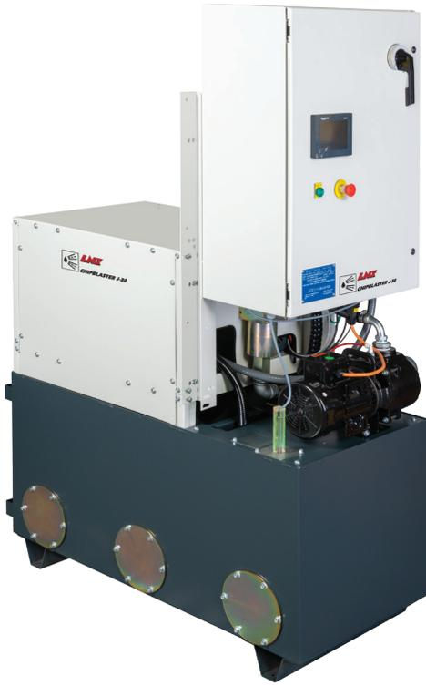
Das CHIPBLASTER J-30 Hochdruck-Kühlmittelsystem ist eine zuverlässige und kostengünstige Lösung, wenn ein Hochdrucksystem mit fixem Volumenstrom gewünscht wird. Dieses Modell eignet sich für Werkzeugmaschinen bis 15 kW.
