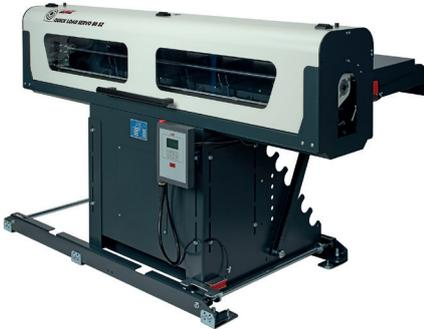
Das Quick Load Servo 80 S2 wurde für die automatische Stangenbeladung kurzer Stangen ausgelegt. Das Gerät verwendet das bewährte Konzept des Quick Load Servo III, wurde jedoch speziell für Standardanwendungen angepasst.
