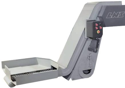
Dank seines zwei Etagen Konzeptes (ein Scharnierband über einem Kratzband) entfernt der Turbo MF2 alle Spanformen verschiedenster Materialien und bietet eine Filterung bis zu 50µm. Das Scharnierband (oben) entfernt grössere Späne, das Kratzband (unten) entfernt feine Späne, die durch das obere Scharnierband fallen.
