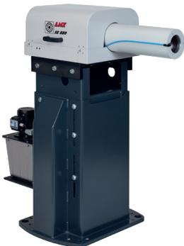
Die LNS-Spindelverlängerung SE 880 ermöglicht das Führen von Stangen bis 1600 mm Länge und ist dadurch die ideale Ergänzung zu einem Kurzstangenlademagazin. Durch die Spindellänge der Drehmaschine und der zusätzlichen Spindelverlängerung können 3 m Stangen in halber Länge beladen und geführt werden. Dies reduziert die Anzahl der Reststücke, verlängert die Autonomie und steigert die Produktivität.
