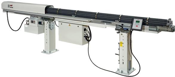
Das Tryton gilt als Marktreferenz beim Führen und Beladen von Stangen im kleinen Durchmesserbereich. Das hydrodynamische Führungssystem in vollständig geschlossenen Führungsrohren gewährleistet eine perfekte und vibrationsarme Stangenführung bei höchsten Drehzahlen.
