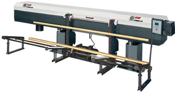
Das automatische Lademagazin für Mittel – und Grossserien im grossen Durchmesserbereich. Die robuste Konstruktion, die hydrostatische Lagerung in den sich öffnenden Führungselementen garantiert ein vibrationsarmes Drehen bei Höchstgeschwindigkeiten.
