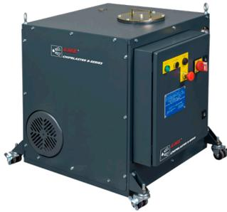
Der Chipblaster B30/35 ist ein unabhängiges, M-Code-gesteuertes Mitteldruck-Kühlschmierstoffsystem mit festem Volumenstrom. Ein einzelner 10-Mikrometer-Plisseefilter, ein automatischer Überlastschutz und ein Filter-Sättigungsalarmkreis sorgen für eine sichere Bearbeitung ohne die Werkzeugmaschine, die Werkstücke und die Werkzeuge zu beschädigen. Ideal für Werkzeugmaschinen bis 15 kW und SK40-Fräser. Auf Rollen stehend lässt er sich leicht bewegen.
