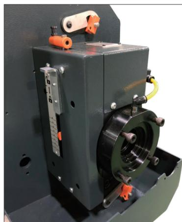
Die weiterentwickelte Lünette mit universellen V-förmigen Führungselementen passt für jeden Rundstangendurchmesser und dämpft Restvibrationen und Geräusche bei allen Durchmessern. Sechskant- und Profilstangen lassen sich mit den optionalen O-förmigen Führungselementen optimal nutzen.
