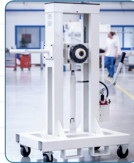
Dient zur Aufnahme, Beförderung vom Rüstplatz zur Schleifmaschine & Bereitstellung der aufgeflanschten Schleifscheiben. Er ist durch zwei feste und zwei lenkbare Rollen flexibel beweglich und wird manuell betätigt. Es gibt zwei höhenverstellbare Aufnahmevorrichtungen, wovon auf einer die neue, auf der anderen die verbrauchte Schleifscheibe aufgesetzt wird.
