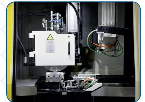
Flachschleifmaschine für hohe Schnittgeschwindigkeiten und große Werkstückgeschwindigkeiten mit Pendelschleiffunktion für keramische CBN- und Korund-Schleifscheiben für max. Umfangsgeschwindigkeit von 200 m/s bei einem Scheibendurchmesser von 400 mm.
