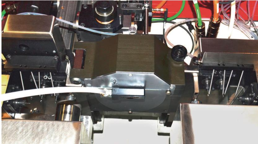
Die beiden Nachbearbeitungseinheiten sind identisch. Sie bestehen aus jeweils einer Gegenspannzange welche auf einem Kreuztisch mit zwei Achsen montiert ist. Das Werkstück in der Gegenspannzange kann mit zwei axialen Spindeln (18'000 min<sup>-1</sup>) und einer Querspindel (18'000 min<sup>-1</sup>) bearbeitet werden. Um die Bohrgeschwindigkeit zu erhöhen oder das Werkstück zu indexieren kann die Maschine optional mit zwei Gegenspindeln mit C-Achse (10'000 min<sup>-1</sup>) ausgerüstet werden.
