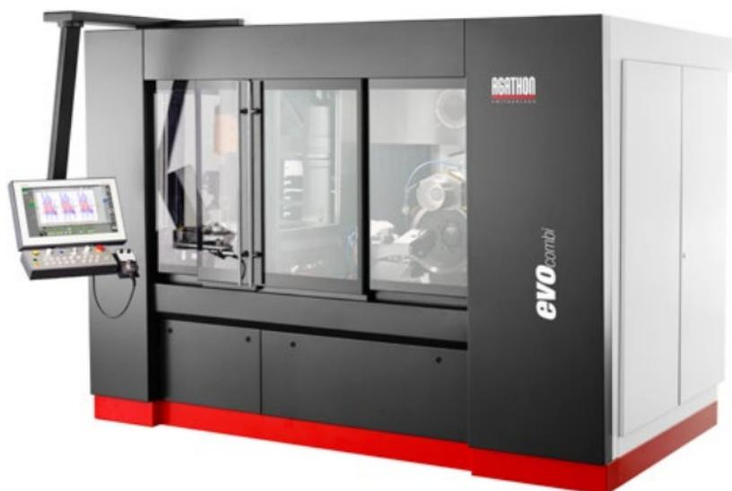
**Hochpräzises 4-Achsen Schleifzentrum zur Bearbeitung von Wendschneidplatten am Umfang mit zwei Schutzfasen in einer Aufspannung**
