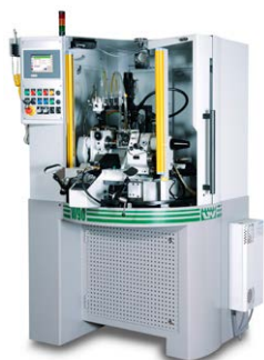
W90 CNC с ЧПУ (Ручная загрузка) Зубофрезерный станок с мелким шагом
